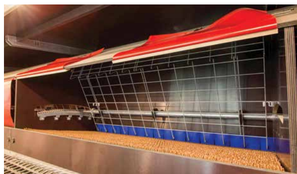
Zamknięcie gniazda z systemem RDE (Rack-Drive Expulsion — system usuwania kur z gniazda z ruchomym stelażem)
