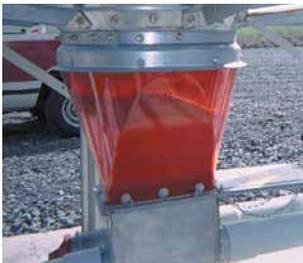
Aufnahmetrichter sind in durchsichtigem oder durchscheinendem roten Polycarbonat erhältlich und gewährleisten die Sichtbarkeit des Futters. Es sind auch 30-Grad-Aufnahmetrichter erhältlich.
