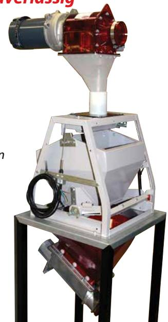
Die Futterwaage von Chore-Time ist ein Diagnosewerkzeug zur Messung der Leistung von Hühner auf der Grundlage von Futteraufnahme und -gewohnheiten.
