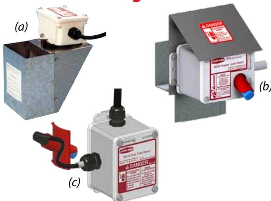
Il comando meccanico del livello della tramoggia (a) viene utilizzato per mantenere il livello di mangime nelle tramogge per una distribuzione costante. Il comando elettronico del livello della tramoggia (b) e l'interruttore del tubo di caduta (c) si adattano automaticamente ai cambiamenti del tipo di mangime. Un ritardo programmabile incorporato previene la riduzione del ciclo.
