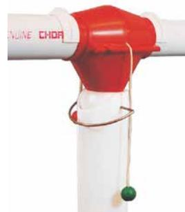
Feed Scale di Chore-Time è uno strumento diagnostico che aiuta a misurare la produttività degli animali in base alla frequenza di alimentazione e alle abitudini alimentari.
