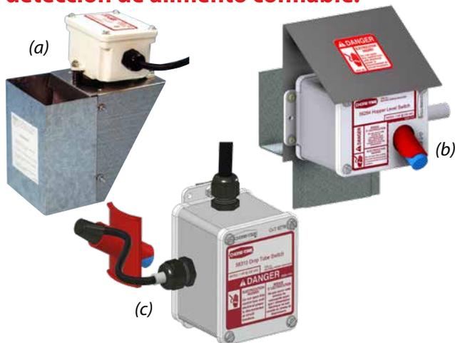
El control mecánico de nivel de la tolva (a) se utiliza para mantener el nivel de alimento en las tolvas para un suministro de alimento continuo. El control electrónico de nivel de la tolva (b) y el interruptor de tubo de caída (c) se ajustan automáticamente a los cambios en el tipo de alimento. Un retardo programable incorporado evita ciclos cortos.
