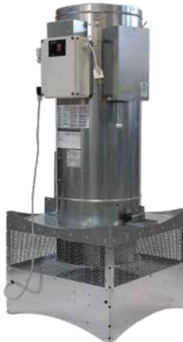
*El desestratificador CUBO® modelo SG/45 está alojado en una caja de acero recubierto de cinc con un ventilador de aluminio para servicio severo. Incluye un quemador de acero inoxidable con ignición por chispa directa. La unidad de control es adecuada para la conexión directa a un control externo de zona.*
