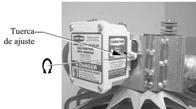
Figura 51. Ajuste del interruptor
