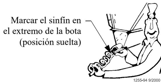
**Figura 37. Medir el sinfín en la posición suelta**
