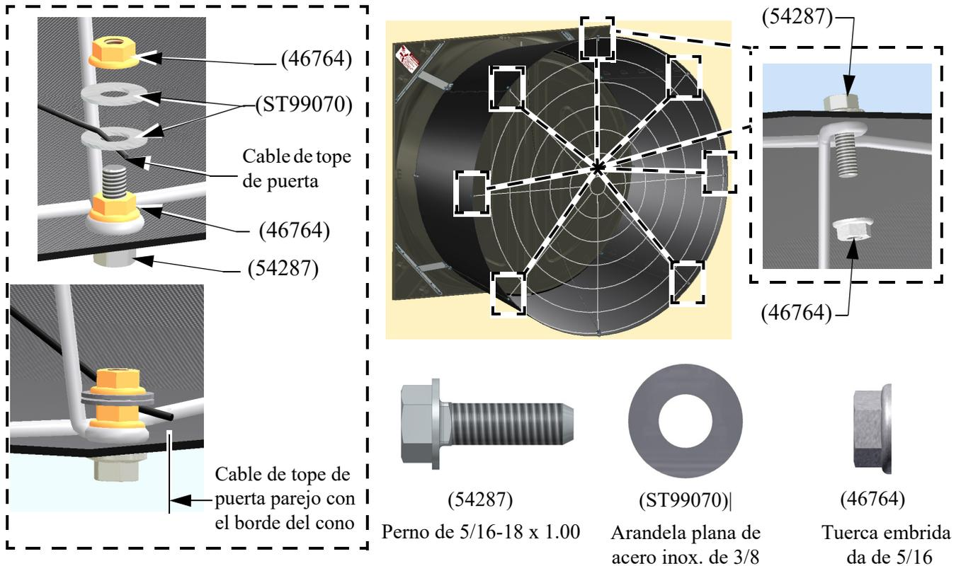
Si se desea montar los ventiladores a la separación mínima, se requiere cortar las rejillas, como se muestra.
