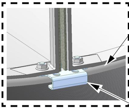
Deslice el marco de orificios detrás de la placa de pivote inferior.
