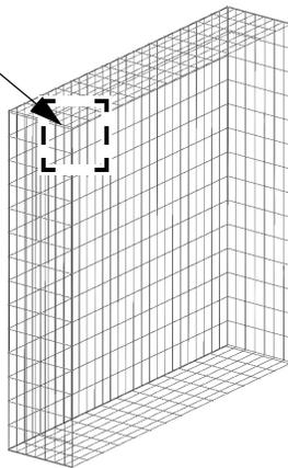
2. Instale un resorte (54480) en la esquina superior izquierda, siguiendo los pasos A a D a continuación. Después de completar el paso D, vaya al paso 3.
