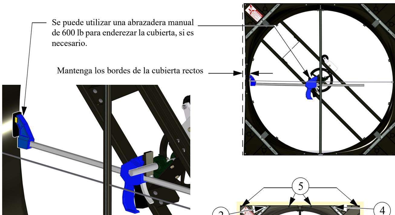
Perfore previamente agujeros a 4,8 mm [3/16"] para evitar el agrietamiento de la madera. Si los agujeros no se alinean con la madera, puede ser necesario colocar tornillos a lo largo de la cubierta. **Importante Fije el ventilador a la pared con tirafondos de 1/4 x 1-1/2" (41561) en la secuencia específico que se muestra. Fíjelo con un total de 20 tirafondos.**
