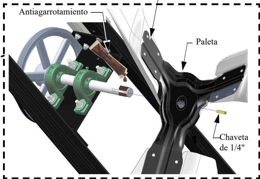
Paleta de ventilador a ras con el extremo del eje.
