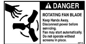
No haga funcionar el ventilador sin las rejillas instaladas. Si no se tienen en cuenta estas precauciones, pueden causarse lesiones graves, incluida la muerte.
