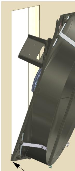
Coloque la cubierta del ventilador en la plataforma inferior.
