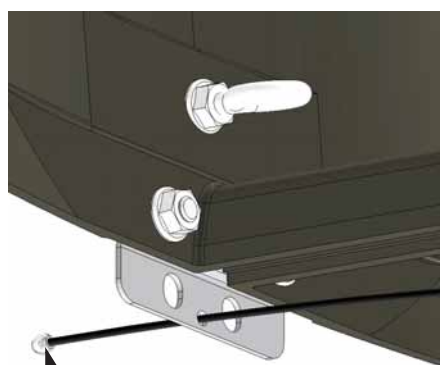
Inserte el conjunto de cable de tope de la puerta (53399) en la placa de pivote superior
