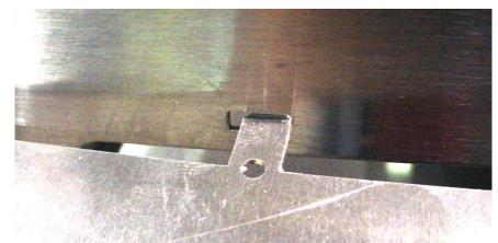
Usando pinzas, doble las orejas para asegurar los deflectores al calentador. Dobla estas orejas hacia la orilla de afuera.
