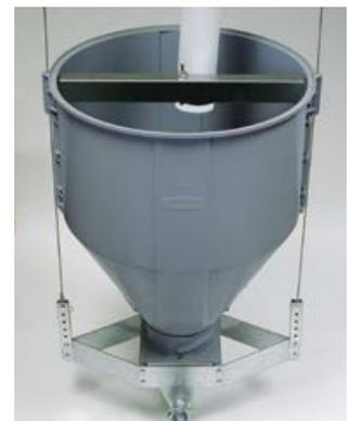
La tolva plástica para la línea de comederos Chore-Time tiene un collar inferior con cierre giratorio, que facilita su extracción para una limpieza en el galpón. La superficie interna lisa y la pendiente de 60 grados de la tolva mejoran el flujo de alimento. Fabricada con plástico de polipropileno durable, tiene capacidad para contener 68 kg (150 libras).
