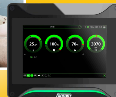
Elektronische regelaar voor varkensstallen
