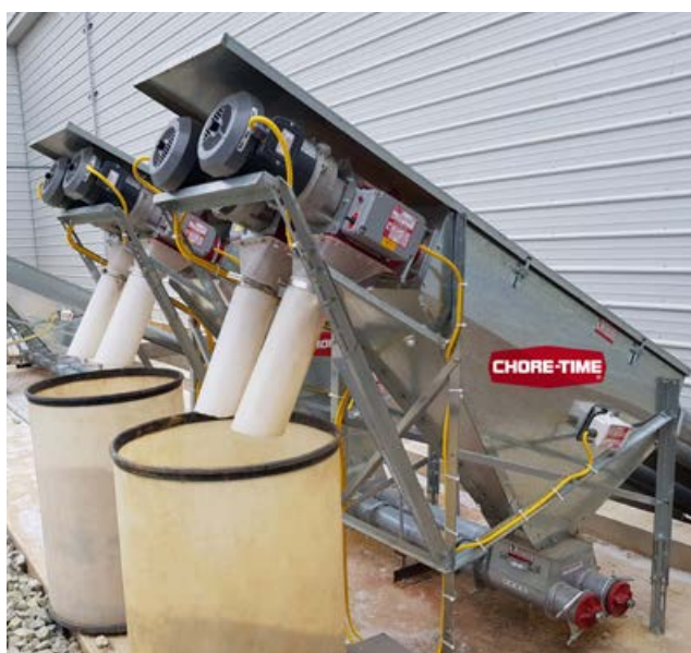
Podwójny liniowy oczyszczacz paszy (dostępny także pojedynczy liniowy oczyszczacz paszy).
