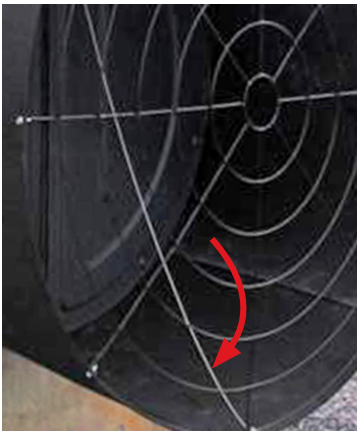
Sposób zamocowania liny pozwala odchylić całe wrota HYFLO® w lewo lub w prawo, zapewniając maksymalną wydajność.
