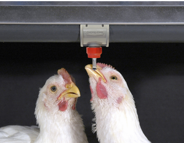
A Chore-Time tenészbarmfi-szelepnek rövidebb a szelepcsapja és kevesebb az oldalirányú mozgása, így mind a tyúkok, mind a kakasok megtanulnak közvetlenül a szelep alatt inni, olyan helyzetből, amely kevesebb vízpazarlást eredményez.
