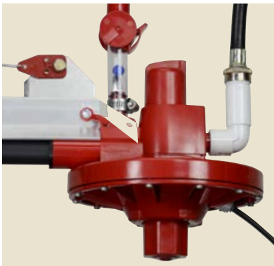
Zelfde VOLUMATIC™-drukregelaar voor luchtdrukgestuurde en reguliere werking. U kunt zelf de standaardwaterdruk selecteren voor het geval de luchtdruk wegvalt.
