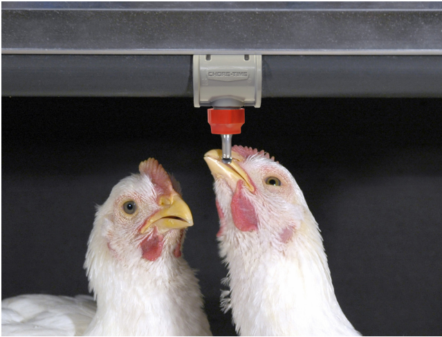
Niplul Chore-Time pentru puii de reproducție are un știft mai scurt și o mișcare laterală mai redusă, astfel încât atât găinile, cât și cocoșii învață să bea direct de sub niplu, într-o poziție din care risipesc mai puțină apă.
