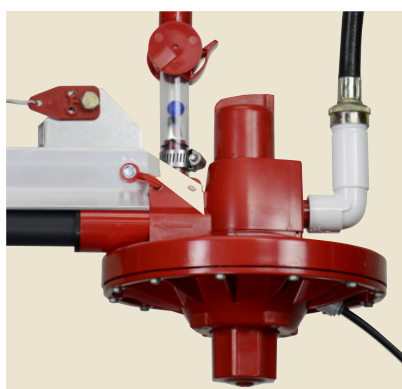
Одна модель регулятора VOLUMATIC™ может использоваться для пневматического и ручного управления. Пользователь может установить давление воды по умолчанию, которое будет использоваться в случае сбоя подачи сжатого воздуха.
