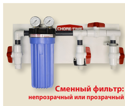
Дополнительные контрольные панели с фильтром поставляются в собранном виде и содержат водяной фильтр, крепление для медикатора и все необходимые детали для установки и подсоединения.
