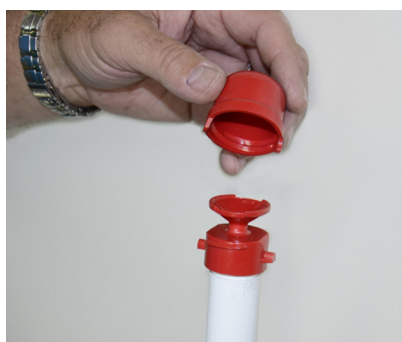
Крышка с сапуном предотвращает попадание пыли в линию подачи воды и быстрее удаляет из нее воздух.
