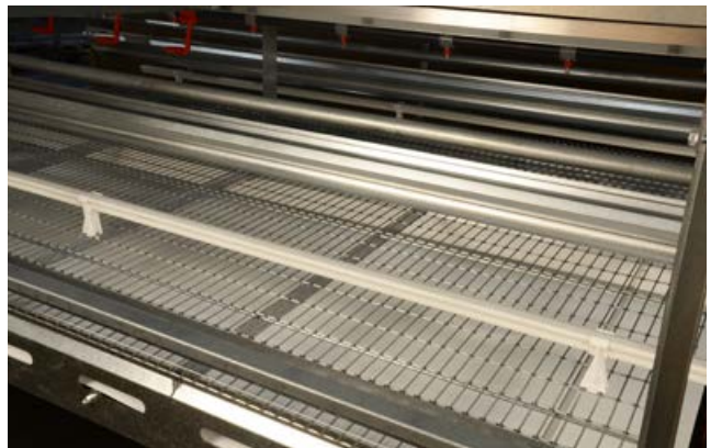
Kotbänder auf jeder Ebene halten das System stets sauber und trocken.
